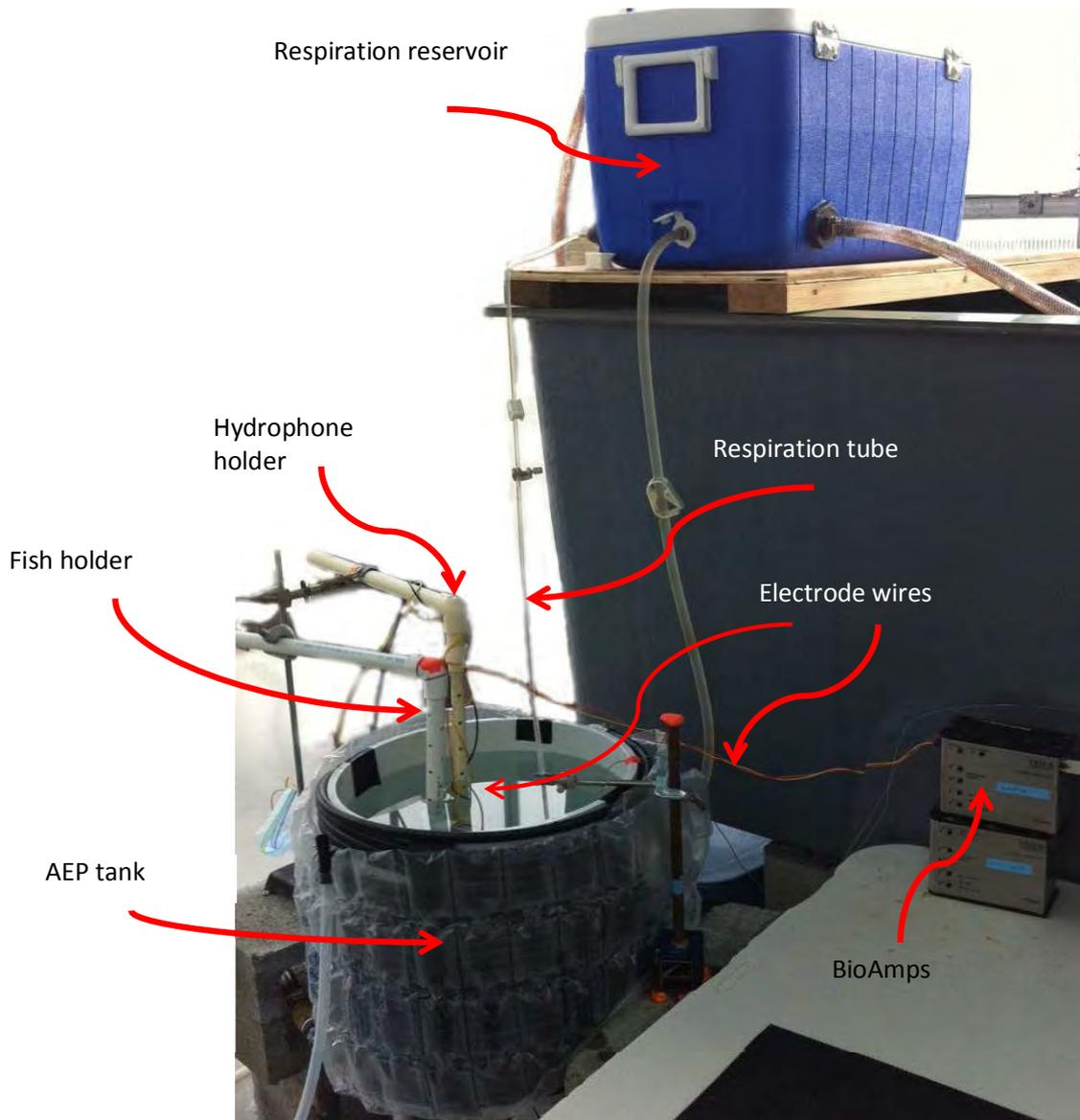
**Figure 4.1.** AEP Setup
